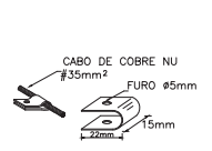
PRESILHA DE LATÃO COM FURO 5 MM SEM ESCALA
